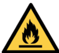
Attenzione: materiale infiammabile
