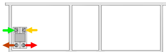
[FIG. 4] Impianto di ventilazione per locale singolo.
