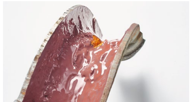
Photo 4 : problème de nettoyage et d'adhérence sur le côté intérieur du coude (source : SSI GE)
