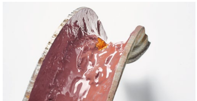
[FIG. 5] Pulizia e aderenza difettose sul lato interno della curva.
