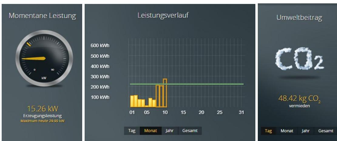
Abbildung 8: Solarlog zur Überwachung der Ertragsleistung der PV-Anlage ([LINK](#) / © FÜRER AG)
